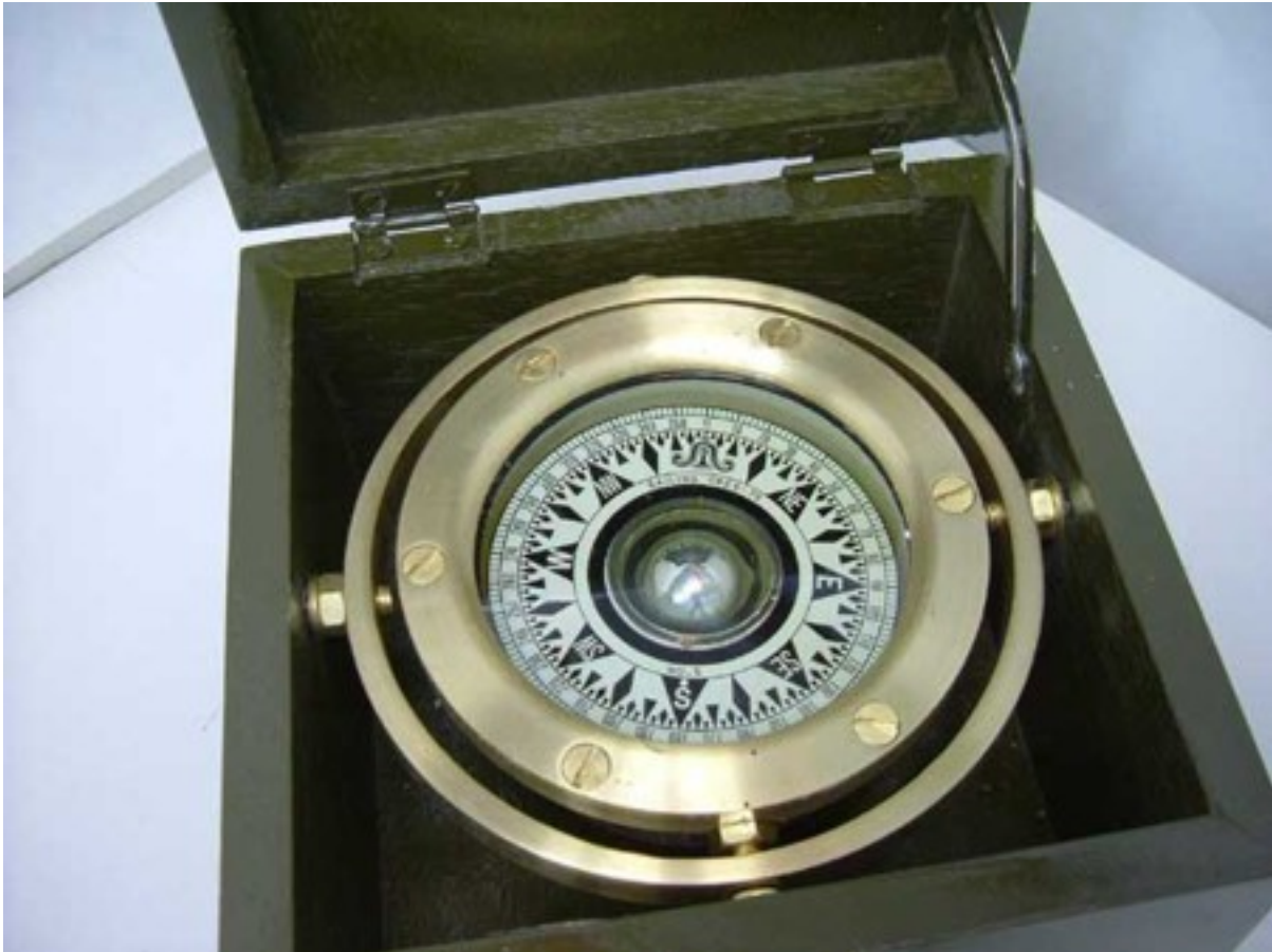
Compás marino moderno con montaje de balancines
