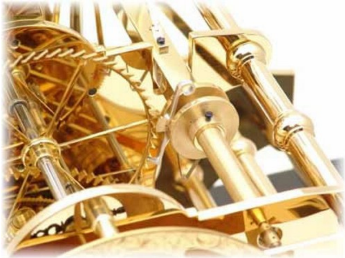
Escape de Saltamontes de John Harrison. Diseñó el reloj con superficies auto-lubricadas (y por lo tanto, no se usaba ningún lubricante)
